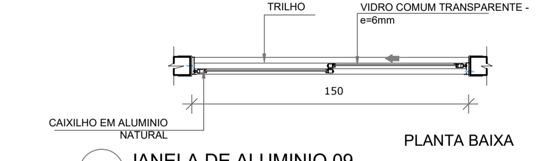
9 JANELA DE ALUMÍNIO 09 ESCALA 1/25
